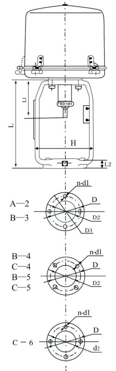
图11 支架与阀门连接螺栓孔尺寸
